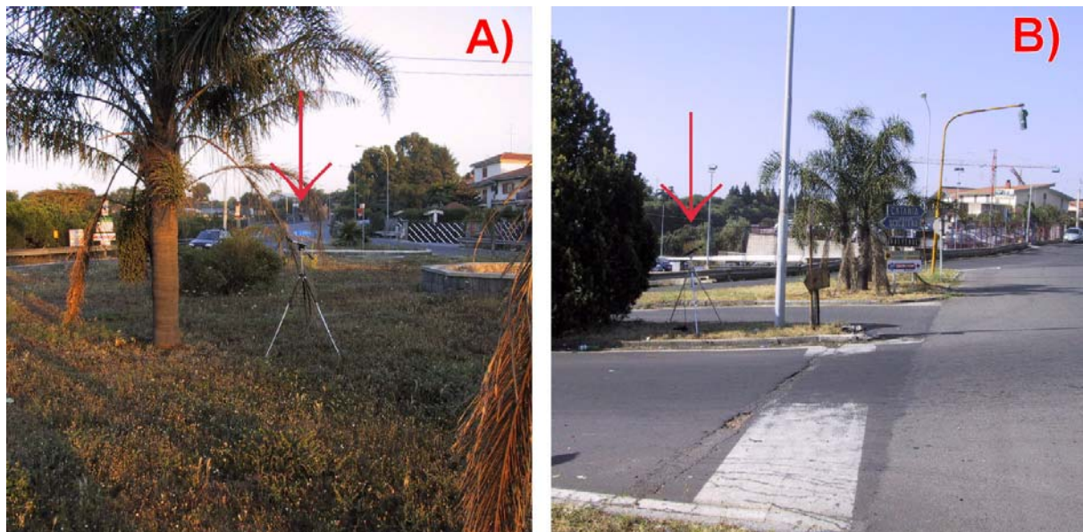
Figura 6. Disposizione dei fonometri: A) sulle rotatorie, B) sulle intersezioni a raso
