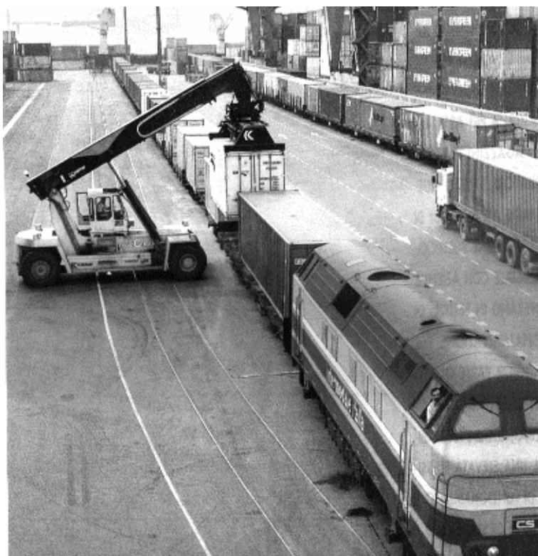
Fig. 6.8 - Integrazione modale strada-rotaia in un interporto.
