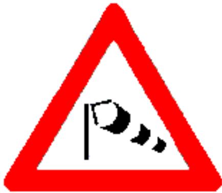
Fig. 4 - Segnale di pericolo che presegna un tratto di strada soggetto a possibili forti raffiche di vento.
