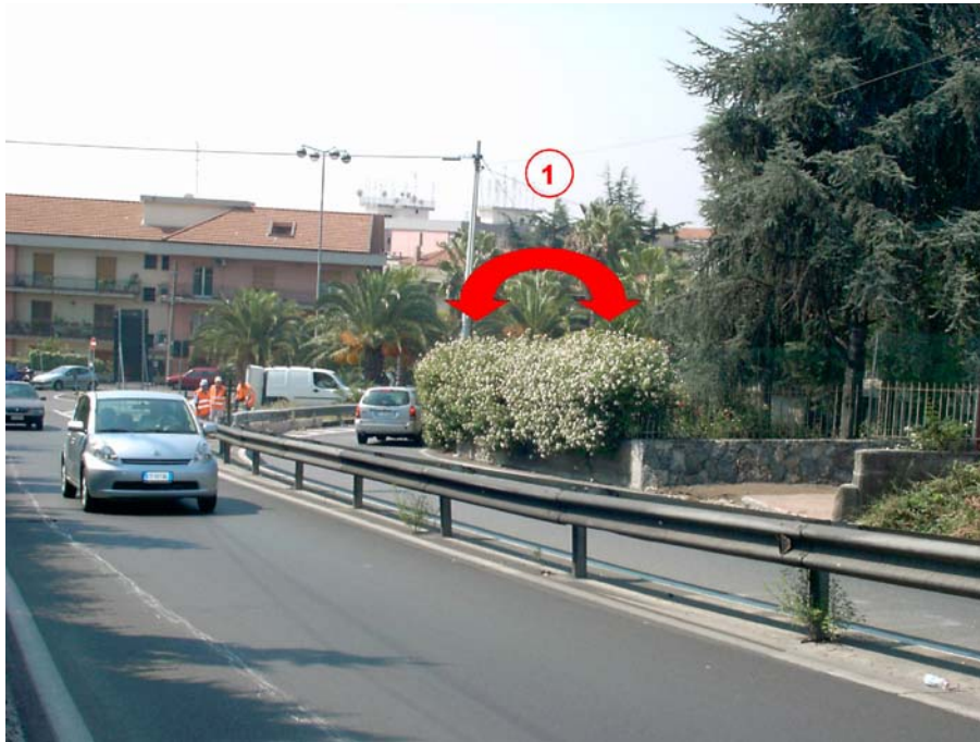
Figura 3. Problemi riscontrati: visibilità ostacolata dalla vegetazione (1); assenza della segnaletica verticale obbligatoria.
