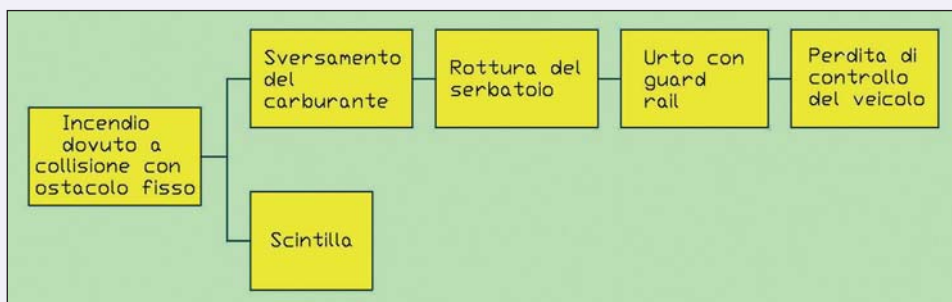
Figura 4 - L'albero delle cause relativo all'incendio nel tunnel di San Martino (Italia, 2007)
