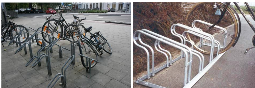
Figura 2.32 Rastrelliere con supporti bassi (da evitare).
